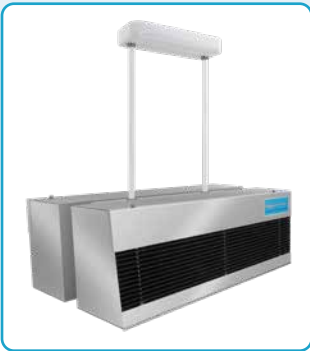
Figura 2 – Muestra la parte superior del Hygeaire® Modelo LIND24-EVO-2PM (arriba). Note los dos agujeros de montaje en la parte superior (para el juego de accesorios de montaje). El equipo debe ser instalado a una altura mínima de 7 pies (2.13 m) medida desde el fondo de la unidad hasta el piso. El punto de montaje debe poder cargar, de forma segura, un peso de 32 libras (14.5 kg).
